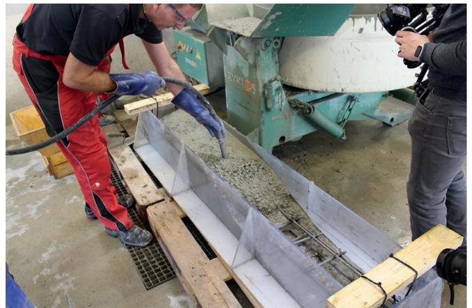
Umfangreiches Versuchsprogramm zur Bestimmung der Verarbeitbarkeit der Stabils-Fasern im Schwenk Technologiezentrum der Firma Schwenk Zement.
