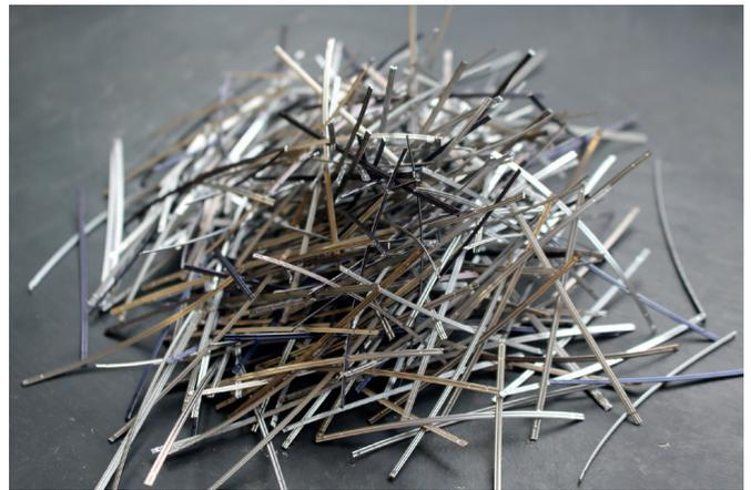
*Die im April dieses Jahres gelaunchte Stabils-Stahlfaser unterscheidet sich schon auf den ersten Blick deutlich von anderen Stahlfasern, da sie eine durchgängig gerade Form aufweist.*
